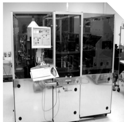
Suss ABC200 AuSn Eutectic, Au-Au, Fusion
